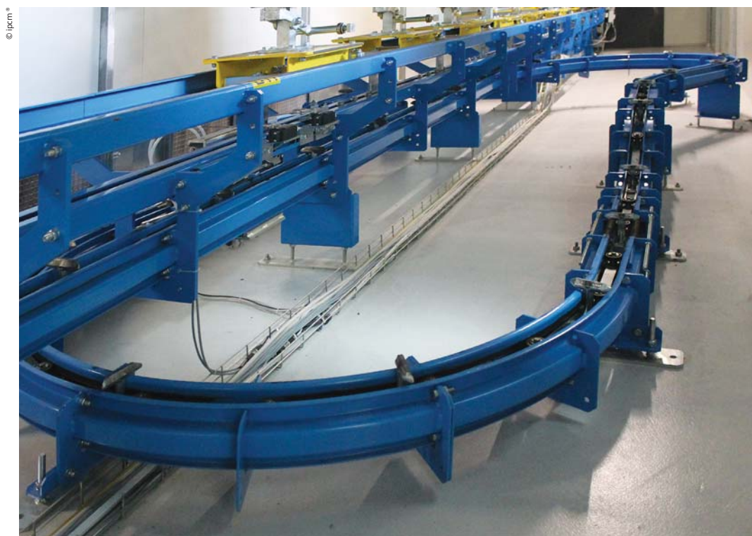
Un dettaglio del trasportatore rovesciato installato da Futura Convogliatori Aerei.
